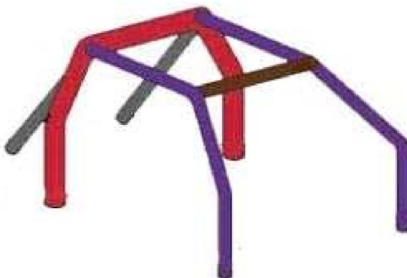
L'arceau principal doit avoir une hauteur suffisante pour qu'une droite tirée de son sommet à celui de l'arceau avant passe au moins 5 cm au dessus du casque du pilote lorsque celui-ci est assis normalement dans le véhicule.
