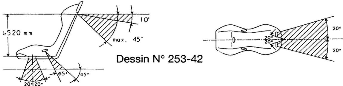
Si les fixations d'origine ne sont pas utilisées, plaques et contreplaques sont obligatoires. La fixation par enroulement sur un tube de diamètre 40mm minimum est autorisée à condition de conserver le système d'immobilisation équipant ces sangles.
