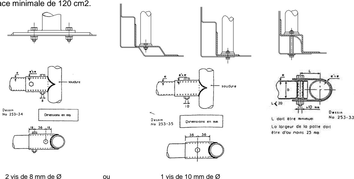
Des tubes de renfort supplémentaires sont autorisés dans la structure de l'arceau cage (tube à tube)
