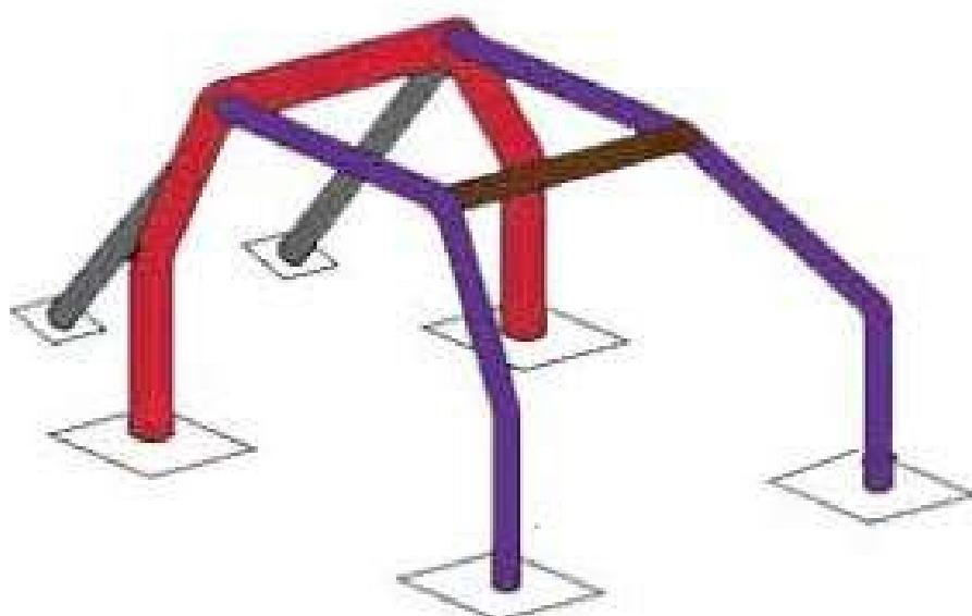
Les entretoises doivent être rectilignes et peuvent être amovibles. L'extrémité supérieure de la diagonale doit rejoindre l'arceau principal à moins de 100mm de sa jonction avec la jambe de force
