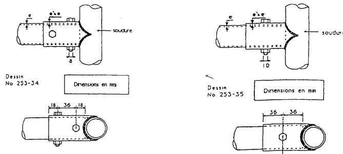
2 vis de 8 mm de Ø      ou      1 vis de 10 mm de Ø
