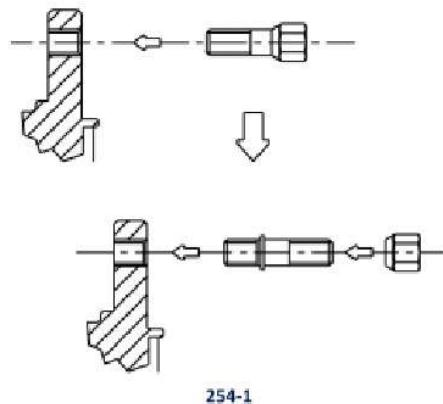
Il est permis de changer les écrous de roues à condition de conserver du matériau ferreux.
