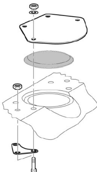
En dehors de la trappe de visite, il est recommandé d'obturer, par des pastilles soudées et collées, tous les orifices du châssis situés autour du réservoir et pouvant communiquer avec l'habitacle.
