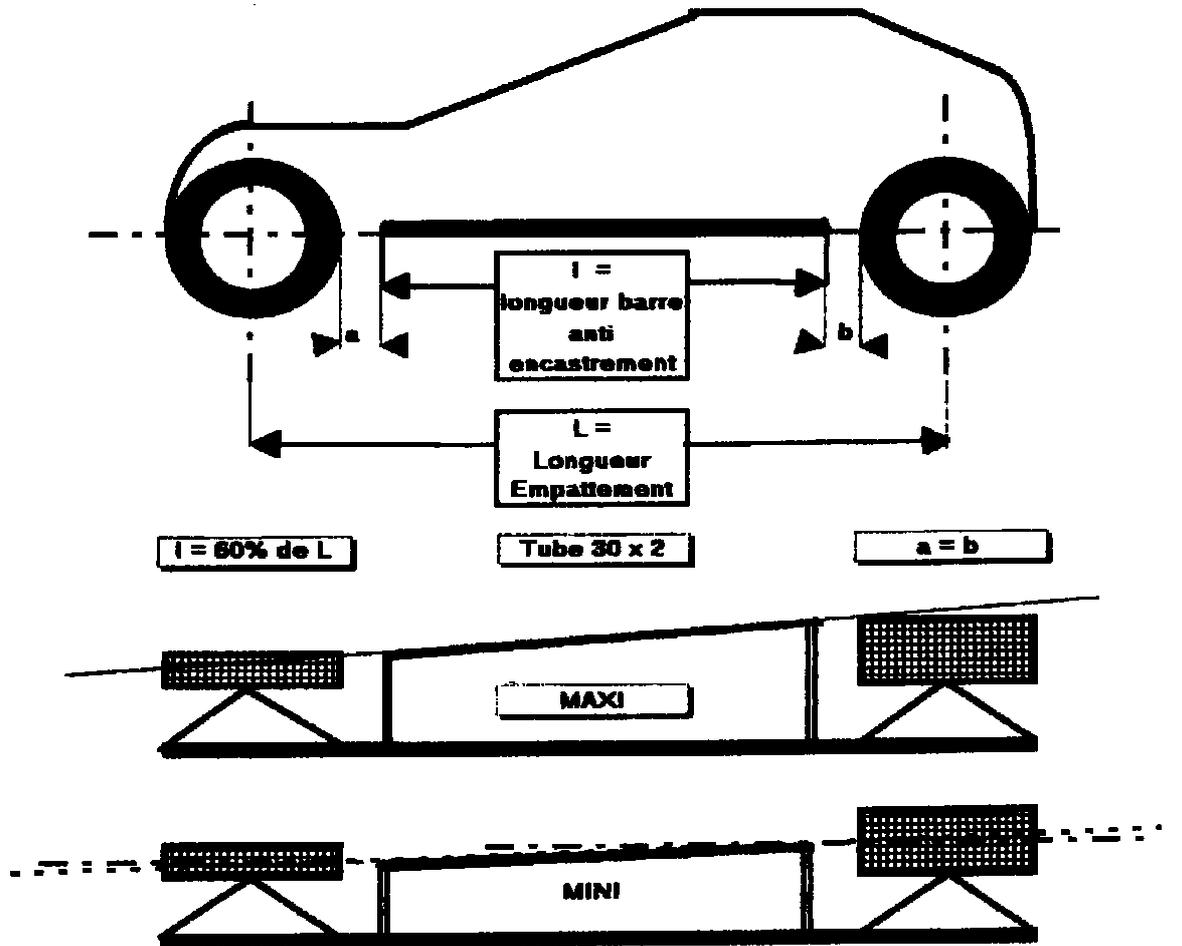
Exemples de dimensions avec : 2 roues de diamètre 500 mm
