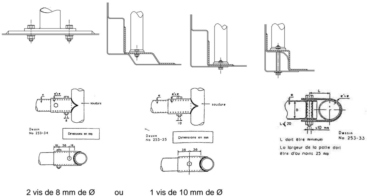
Des tubes de renfort supplémentaires sont autorisés dans la structure de l'arceau cage (tube à tube)
