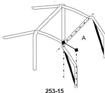
Une cloison métallique solidaire du plancher et des 2 montants postérieurs de l'arceau de sécurité est obligatoire, jusqu'au toit et sur toute la largeur de l'habitacle (cloison pare-feu).
